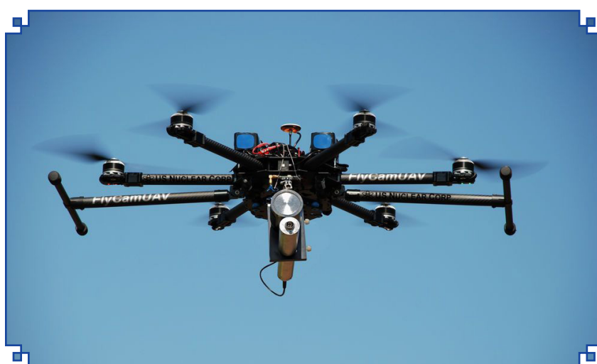
دستگاه‌های تشخیص آلودگی پرتویی نوع ثابت و متحرک
