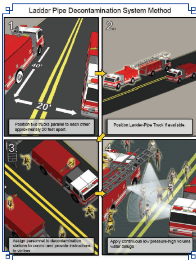
شکل (۷-۵)، آلودگی‌زدایی توسط ماشین‌های آتش‌نشانی با سیستم LDS
